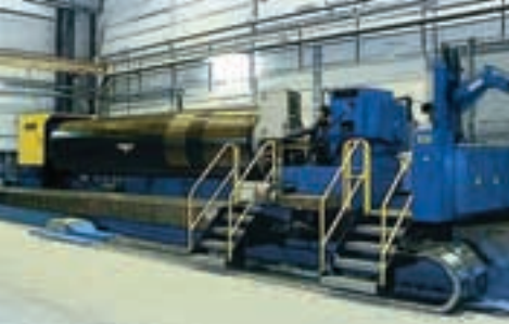
AK-Tehdas Oy:n uusi CNC- sorvi/hiomakone, jolla voidaan kunnostaa jopa yli 80 tonnin painoisia teloja.
