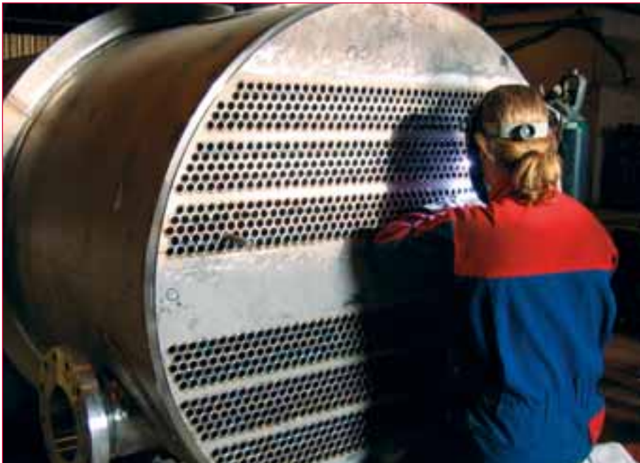
Ruotsiin Perstorpille toimitettavan lämmönvaihtimen hitsaus.
